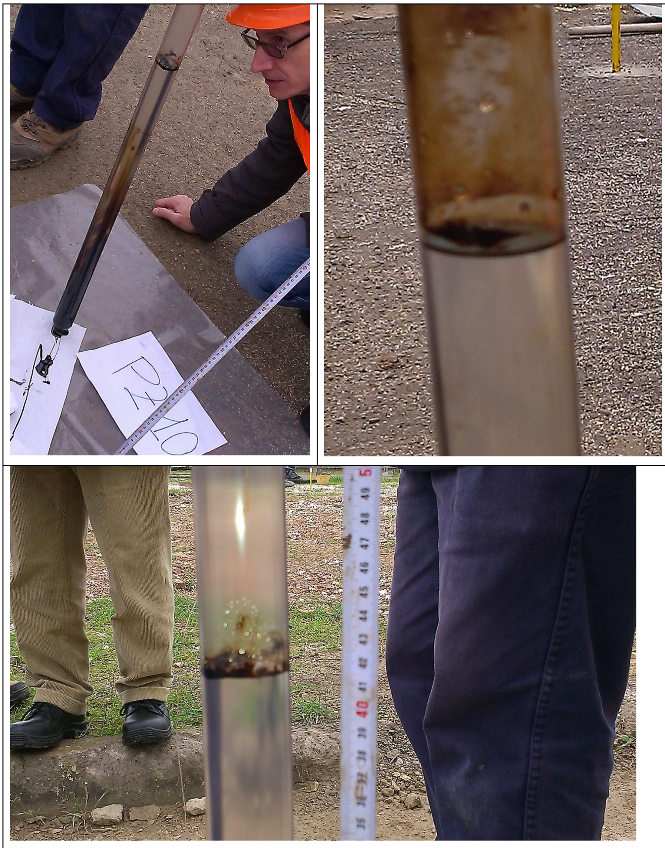
Figura 9. Bailer utilizzato per il prelievo dal piezometro PZ10 e particolari dell'interfaccia
