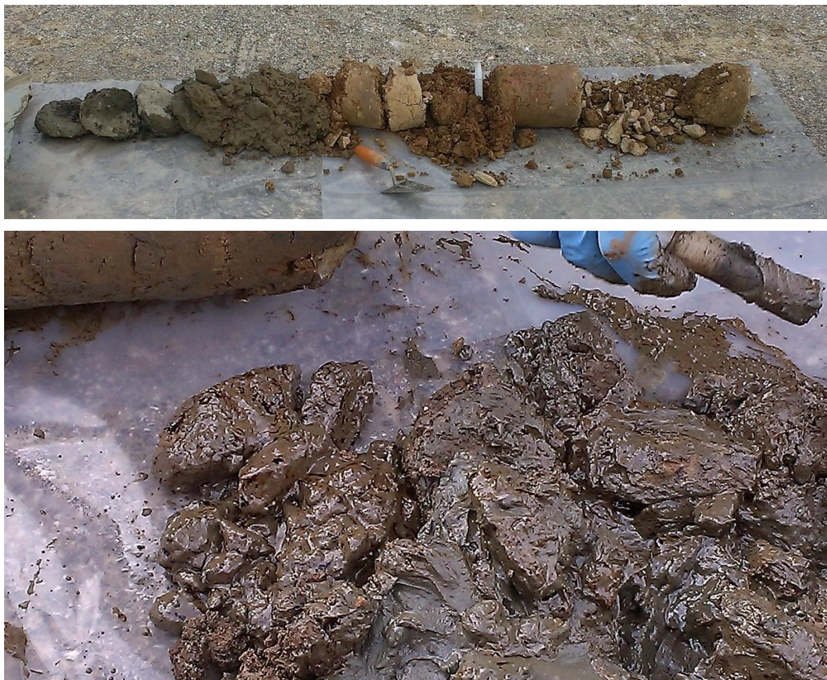
Figura 3. Carote relative al punto di prelievo SC03 con evidenziate le posizioni di campionamento
